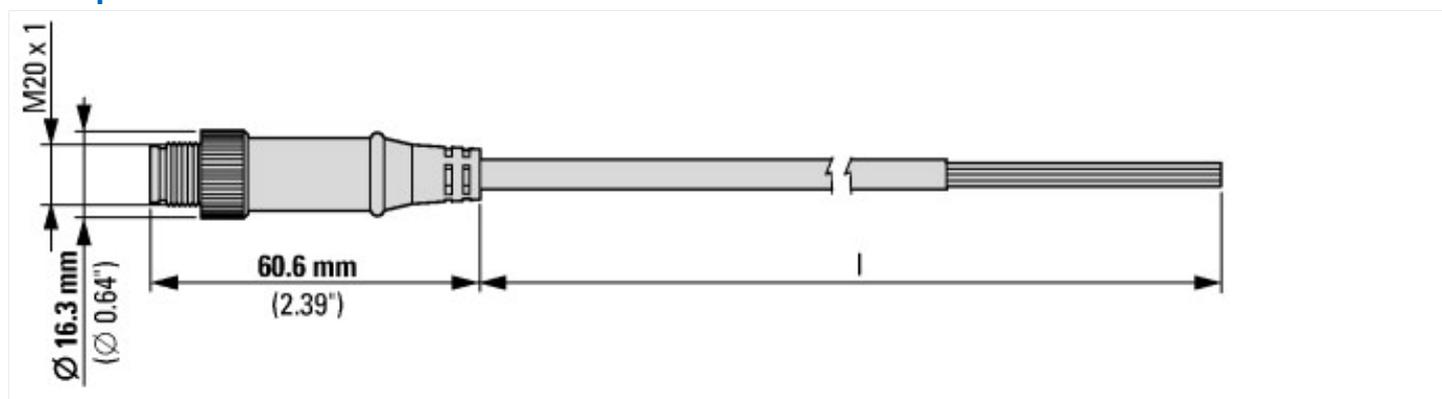
В/В провод круглого сечения M12, оконцованный с одной стороны
