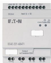
Модуль расширения ввода / вывода, CANopen, 24VDC, 6DI, 4DO (T)
