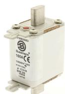
Предохранитель, высокая скорость, 160 А, АС 1000 V, 125 кА, DIN 00, aR, DIN, IEC, Индикатор типа Т, токоведущие зажимные язычки
