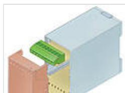
Соединительные клеммы для горизонтально вставленных печатных плат
