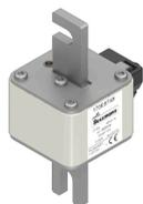
Предохранитель, высокая скорость, 315 А, АС 900 V, 50 кА, DIN 2, аR, DIN, Индикатор типа К
