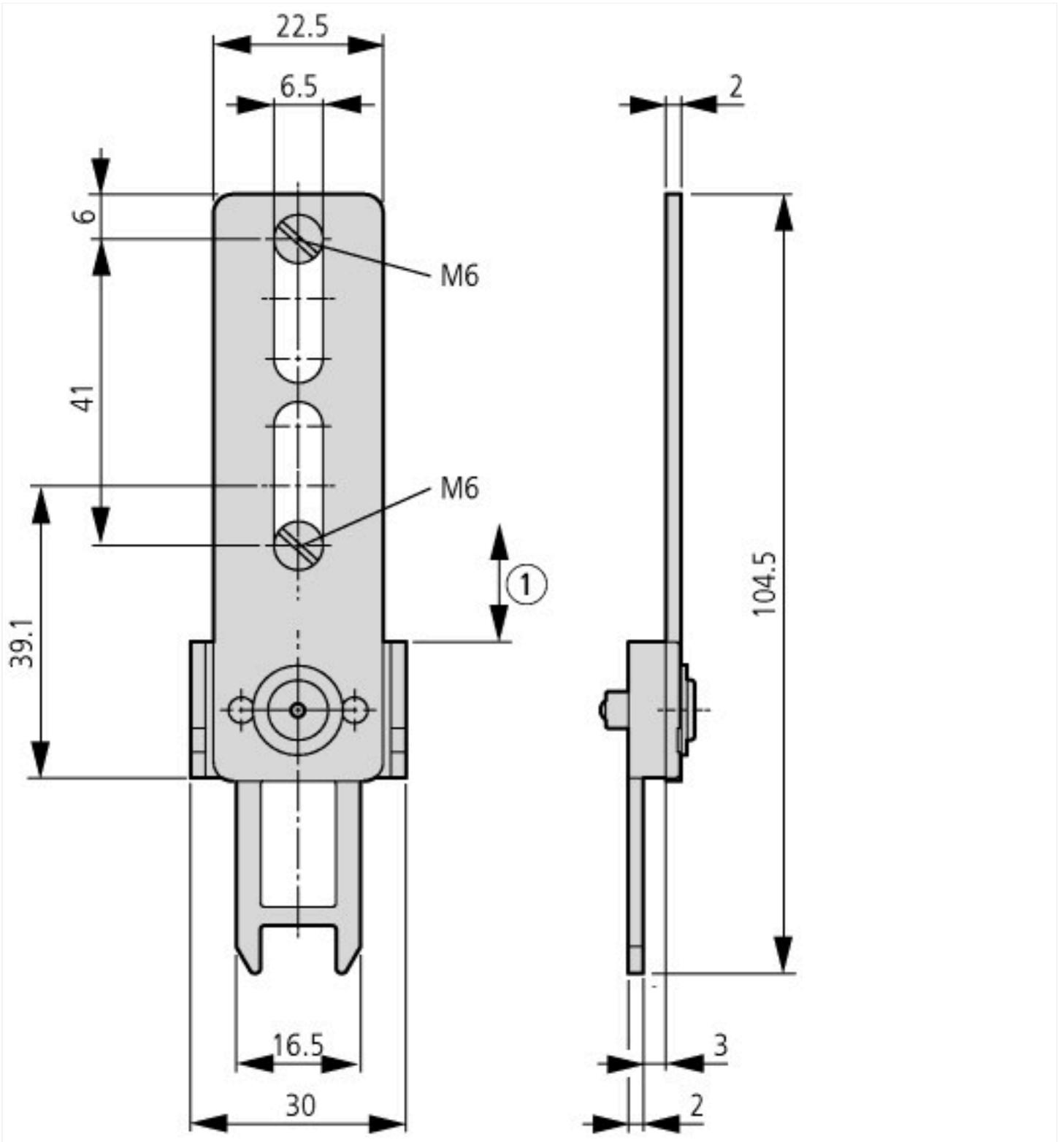
① Расстояние до головки устройства = 0,1 ... 3,0 мм
