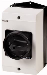
Переключатель включения/выключения, P3, 63 А, Монтаж на поверхность, 3-полюсн., 1 Замыкающие контакты, 1 Размыкающие контакты, Функция останова, с черной поворотной ручкой и с храповым венцом, запираемый в положении 0
