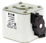
Предохранитель, высокая скорость, 800 А, АС 950 V, 100 кА, size 3, 76 x 92 x 75 mm, aR, IEC, Индикатор типа К
