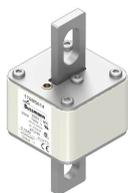
Предохранитель, высокая скорость, 800 А, АС 690 V, 200 кА, size 2, 61 x 77 x 135 mm, aR, IEC, UL, без индикации, По требованиям США, 90 мм крепежные центры
