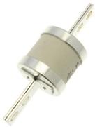
Предохранитель, низкое напряжение, 560 А, AC 550 V, DC 400 V, 80 кА, BS88/C2, 74 x 210 mm, gL/gG, BS
