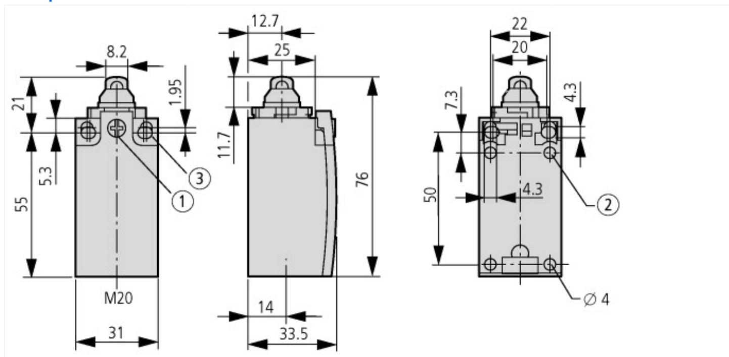
① Вращающий момент затяжки винта крышки: 0,8 Нм ±0,2 Нм
