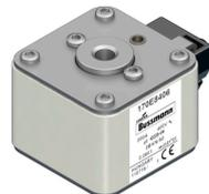
Предохранитель, высокая скорость, 800 A, AC 400 V, size 2, aR, IEC,
