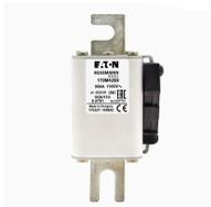
**Предохранитель, 550 А, AC 690 V, size 1, 53 x 69 x 111 mm, aR, IEC, визуальный индикатор**
