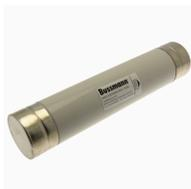
Воздушный предохранитель, среднее напряжение, 63 А, AC 12 kV, 40 кА, 3", 359 x 76.2 mm, резерв, BS, с наклейкой
