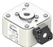
Предохранитель, высокая скорость, 1100 А, AC 690 V, 200 кА, size 3, 76 x 92 x 53 mm, aR, IEC, UL, Индикатор типа К, Резьба США
