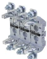
Держатель предохранителей, низкое напряжение, 160 А, AC 690 V, NH00, 3P, IEC, монтаж на DIN-рейке
