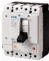
Втычной автоматический выключатель 125А, 4 полюса, откл.способность 25кА
