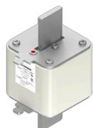
Предохранитель, высокая скорость, 500 А, АС 1250 V, 100 кА, size 3, 76 x 76 x 150 mm, aR, IEC, Индикатор типа Т, токоведущие зажимные язычки
