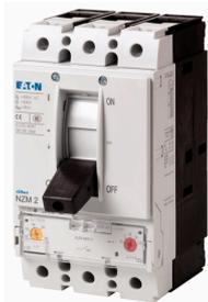
Автоматический выключатель 250А, 1000В АС, 3 полюса, откл.способность 150кА, диапазон уставки 200...250А
