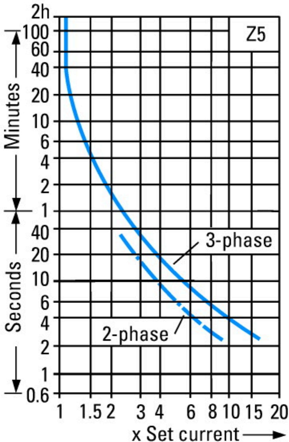
Эти характеристики отключения являются средними значениями разброса при температуре окружающего воздуха 20 °С в холодном состоянии.
