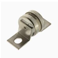
Предохранитель, высокая скорость, 400 А, AC 240 V, DC 150 V, 200 кА, BS88, 38 x 84 мм, aR, BS
