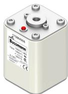
Предохранитель, высокая скорость, 700 А, АС 1000 V, 100 кА, size 1, 53 x 53 x 75 mm, aR, IEC, одинарный индикатор
