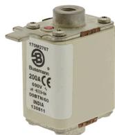
Предохранитель, высокая скорость, 250 A, AC 690 V, 200 кА, size 00, 30 x 62 x 64 mm, aR, IEC, Индикатор типа T
