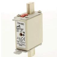
Предохранитель, высокая скорость, 63 А, АС 690 V, 200 кА, DIN 000, gR, DIN, IEC, Индикатор типа Т, квадратный корпус с ножевыми контактами
