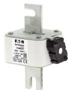
Предохранитель, высокая скорость, 900 А, АС 1250 V, 100 кА, size 3, 76 x 92 x 139 мм, aR, DIN, IEC, Индикатор типа К
