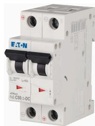
Автоматический выключатель для защиты цепей пост. тока 50А, кривая отключения C, 2 полюса, откл. способность 10 кА
