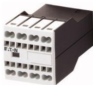
Вспомогательный контактный модуль, 4-полюсн.,  $I_{th}= 16 A$ , 3 замык, 1 разм., Фронтальная установка, Пружинные клеммы, DILA, DILM7 - DILM38
