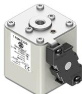
Предохранитель, высокая скорость, 315 А, АС 1250 V, 100 кА, size 2, 61 x 75 x 77 mm, aR, IEC, UL, Индикатор типа К
