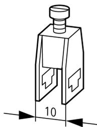
Компактная клемма, max.16 мм<sup>2</sup>
