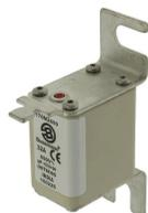
Предохранитель, высокая скорость, 32 А, АС 690 V, 200 кА, DIN 00, 30 x 67 x 100 mm, gR, DIN, IEC, Индикатор типа Т
