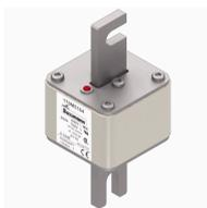
Предохранитель, высокая скорость, 800 А, АС 690 V, 200 кА, DIN 2, 61 x 61 x 108 мм, aR, DIN, IEC, одинарный индикатор, 110 мм крепежные центры
