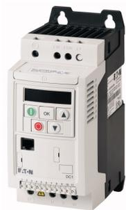
Преобразователь частоты, 115 В перем. тока, однофазн., 2.3 А, 0.37 кВт, IP20/NEMA 0, FS1
