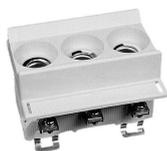
Держатель предохранителей, низкое напряжение, 16 А, AC 400 V, D01, 3P, IEC, подходит для проводов сечением 1,5 - 4 мм<sup>2</sup>
