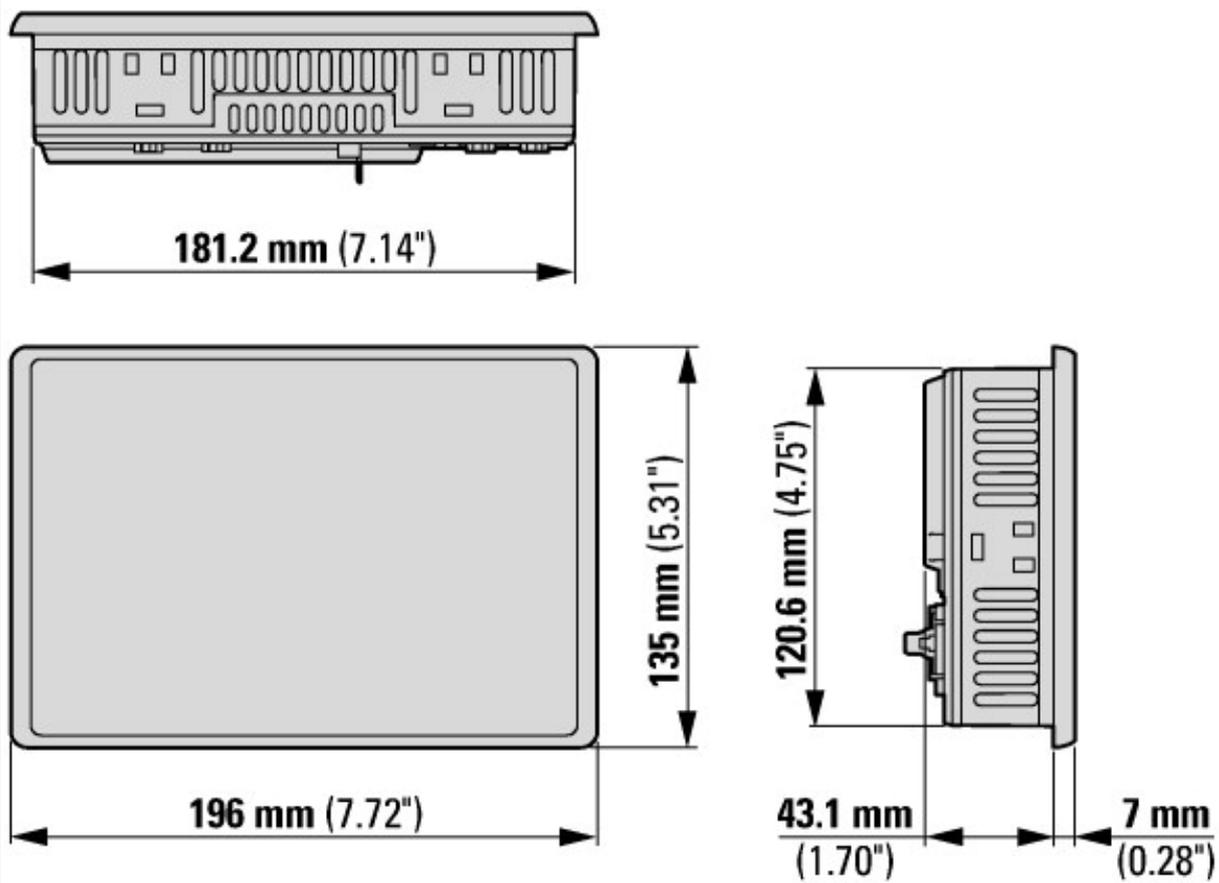
Панель мультитач XV-303-... с диагональю экрана 7" Вариант: для монтажа в вырез на передней панели
