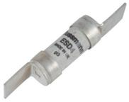
Предохранитель, низкое напряжение, 4 А, AC 550 V, 80 кА, BS88/F2, 14 x 68 mm, gL/gG, BS
