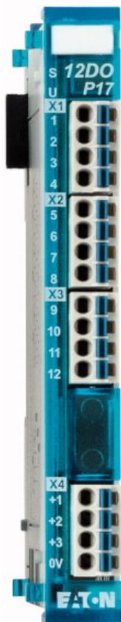
**Цифровой модуль вывода; 12 цифровых выходов, устойчивых к коротким замыканиям, по 24 В постоянного тока/1,7 А; переключающий плюс**
