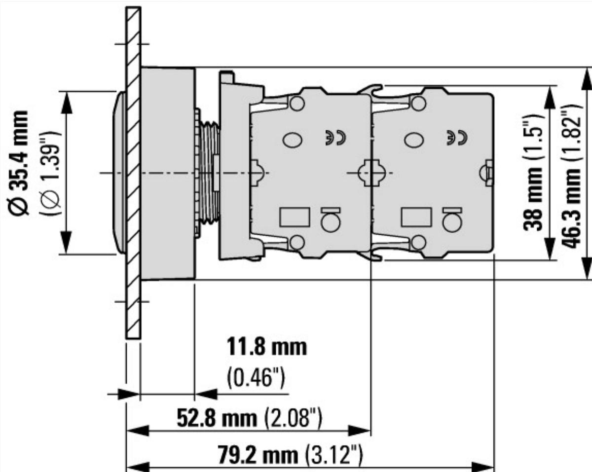
с 2 стандартными контактными элементами M22-К...
