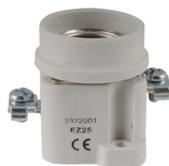
Держатель предохранителей, низкое напряжение, 25 А, AC 500 V, D2, 1P, IEC, монтаж резьбовым соединением, подходит для проводов сечением 1 - 10 мм<sup>2</sup>
